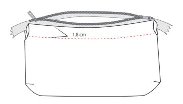
⑥缝制拉链袢在拉链的头尾处。 将里布的返口缝合,将医生口金穿在袋口处。
