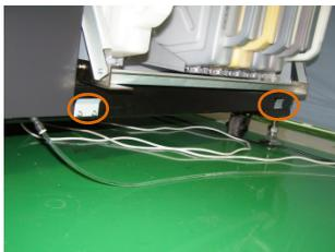
松开 4 个螺钉，松开金属零件
