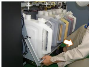
向外拉主墨罐模块，直至接触到止动器
