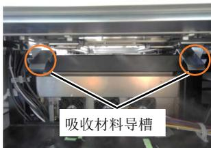
将字车用吸收材料放置在吸收材料导槽的斜面上
