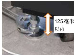
旋转固定支脚（4 处）的下侧螺母，调整水平
