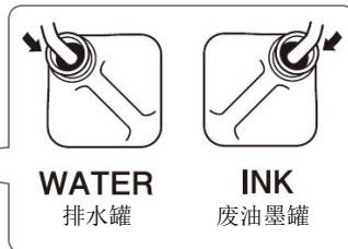
确认罐孔的方向，并按标签所示设置罐
