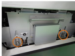
使用一字螺丝刀拆下盖帽固定板
