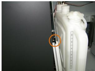
拆下连接带，拔出管
