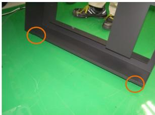
将主墨罐罩盖的切口插入步骤 3.中松开的金属零件中
