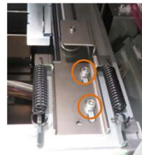
松开字车皮带支架的 2 个螺栓
