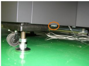
松开本体右侧左下方罩盖上的 2 个螺钉
