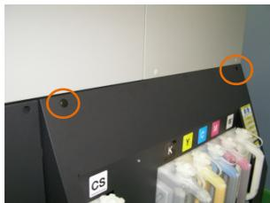
在主墨罐罩盖的 2 个通孔位置安装黑色孔塞
