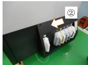
沿②的方向牢固插入，紧固暂时安装的 2 个主墨罐罩盖安装螺钉 (M4)和松开的 4 个螺钉
