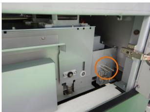
将随附的凸轮固定销安装至维护模块进行保管，并关闭门
