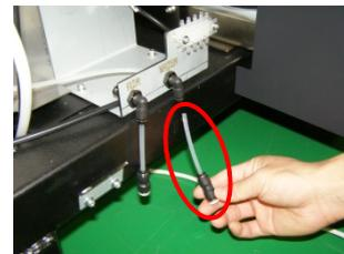
※使用连接直径为 4 毫米的管时，应拆下。
