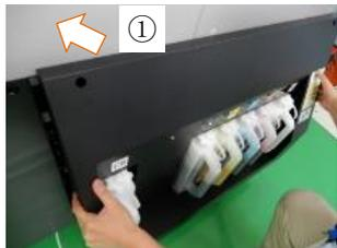
将各罐的盖帽所随附的连接带向前对齐，向上抬起主墨罐罩盖，沿①的方向滑动，直至超过罐的盖帽。
