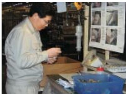
对树脂进行再利用时，制作管理工序表，去除密封条等异物。
