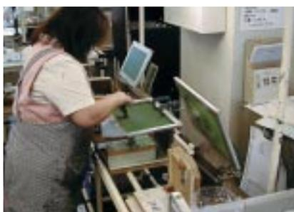
采用丝网漏印法进行缝纫机商标印刷
