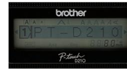
打印前可预览文本。液晶显示屏无法一次显示所有文本时，可按左右方向键显示隐藏文本。
